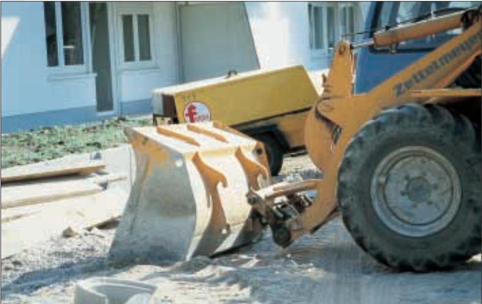
An- und Abbau der Arbeitswerkzeuge durch Schnellwechseleinrichtung
