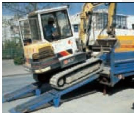
Am Fahrzeug angebrachte abklappbare Auffahrrampe mit Abstützung
