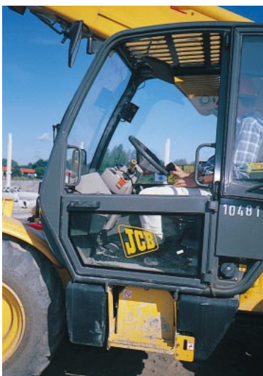
Abb. 7: Fahrerplatz in der vollverglasten Kabine mit sicherem Zugang
