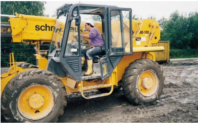
Abb. 9: Sicht einschränkung für den Fahrer zur Seite und nach hinten durch die Anordnung des Teleskoparmes
