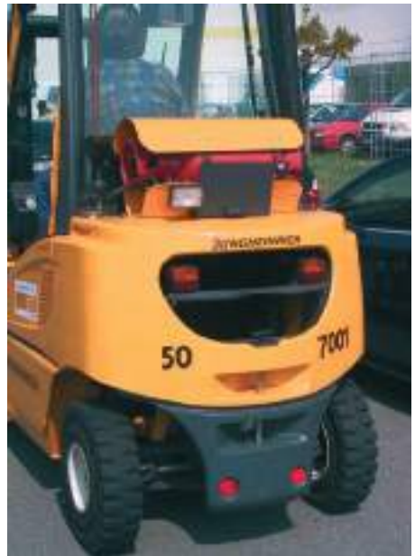
Abb. 3: Schlussleuchten, Bremsleuchten, Rückstrahler und Fahrtrichtungsanzeiger
