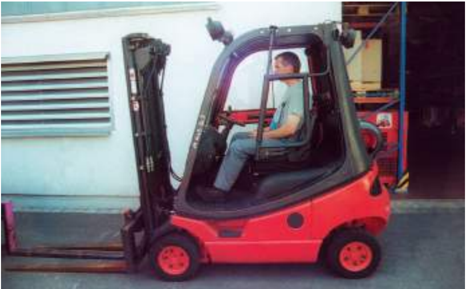
Bild 4: Türbügelrückhaltesystem; Nachrüstsatz für FFZ mit Fahrerschutzdach der Linde AG.
