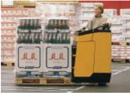
Bild 1: Flurförderzeug mit einstellbarem Komfortsitz: geeignet für hohe Umschlagleistung, lange Transportstrecken und intensive Einsatzzeiten. Foto: Jungheinrich
