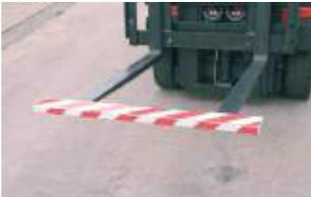
Abb. 2: Schutzvorrichtung zum Abdecken der Gabelspitzen
