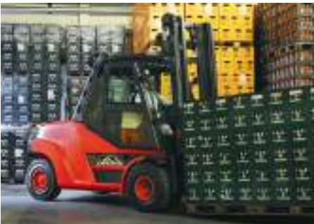
Bild 6: In der Ausbildung gelernt – so haben Sie Last und Gabelstapler sicher im Griff: Last möglichst bis auf 20 cm zum Boden absenken und Hubmast nach hinten neigen.
